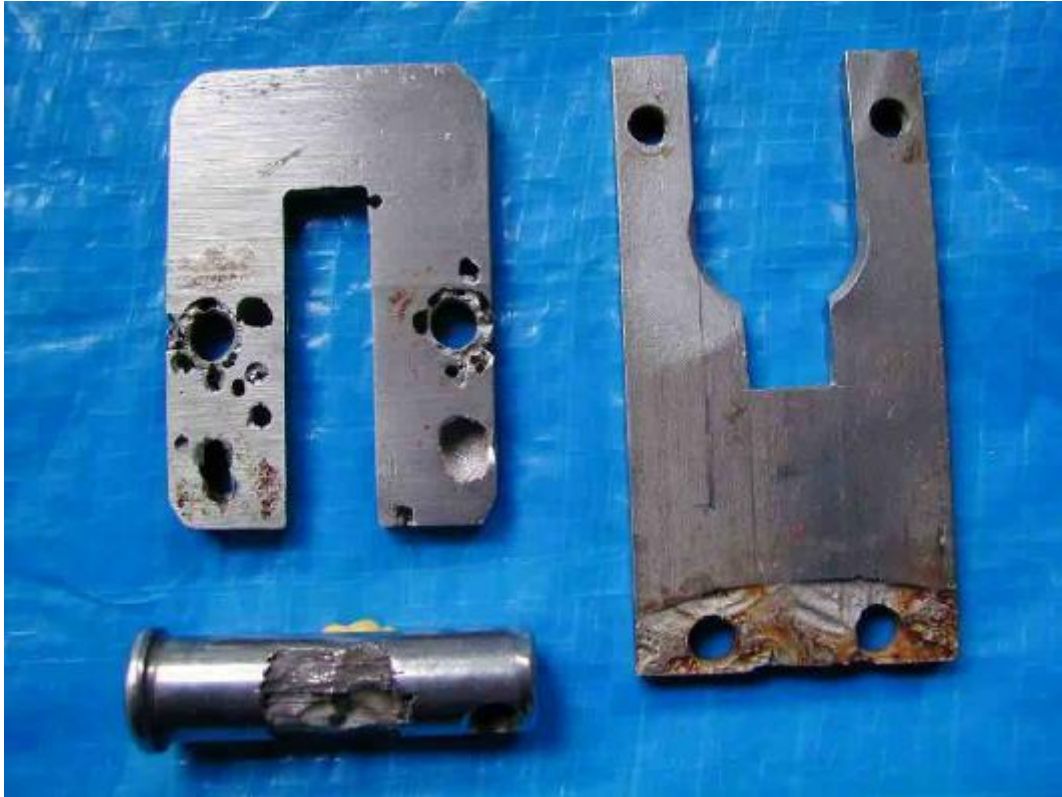
Figure 29 : Pieces d'acier "inoxydable" corrodées par un séjours en eau de mer
