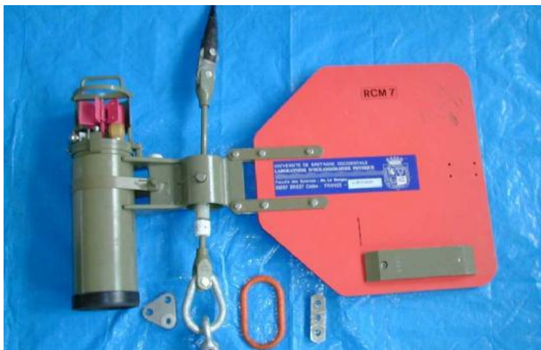
Figure 24 : Courantomètre Aanderaa RCM7 et divers éléments de liaison permettant de reprendre la tension dans la ligne de mouillage
